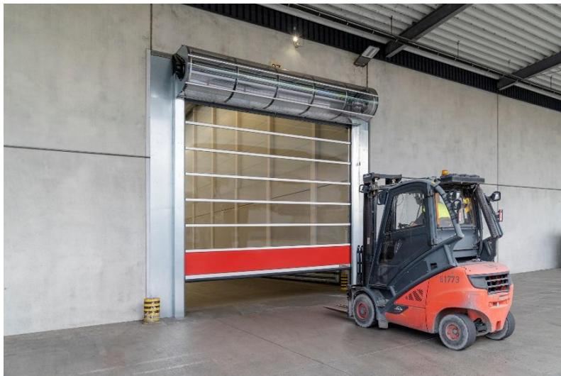
**Bild 3:** Die Spiraltore HS 5040 TurboLux sind als Innen- und Außentore einsetzbar. Der Torbehang ist zu 90 Prozent transparent und kann auf Wunsch foliert werden. Die Tore werden vormontiert geliefert und lassen sich von zwei Monteuren innerhalb eines Tages montieren.
