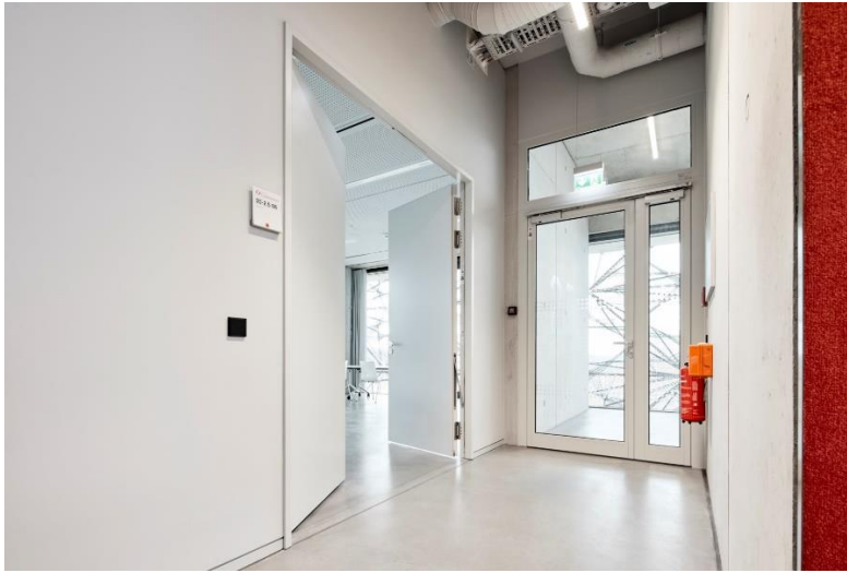
Bild 10: Die verglasten Aluminium-Rohrrahmenobjekttüren von Hörmann sorgen für Brandschutz und zeitgleich für Transparenz.
