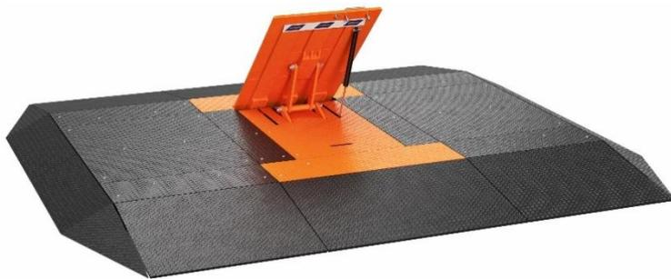
**Bild 2:** Der mobile Road Blocker M30 von Hörmann wird im praktischen Baukastenprinzip geliefert. Im mittleren Modul befindet sich das 800 mm hohe Sperrelement. Die seitlichen Module für den Fußgängerdurchgang sorgen für Entfluchtungsmöglichkeiten und für eine Passierbarkeit für beispielsweise Rollstühle oder Kinderwagen.
