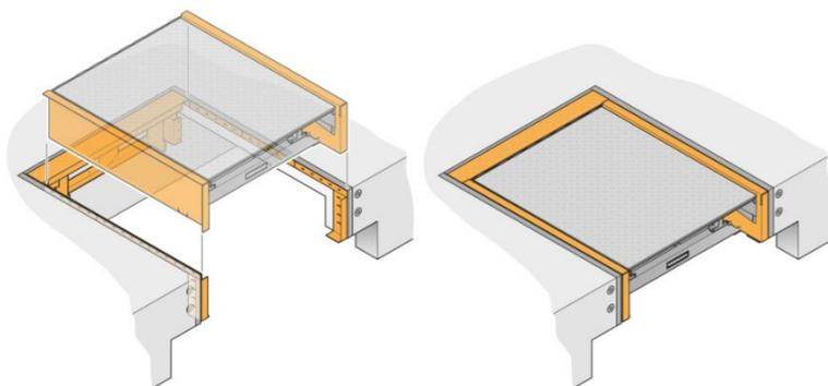
**Bild 2:** Ist die bestehende Grube zu breit oder zu lang für eine Standardgröße, kommt das neue Einbaumodell HTL3-R zum Einsatz. Variable Adapter passen die Ladebrücke bedarfsgerecht in die Grube ein.
