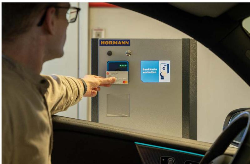
**Bild 2:** Mit Hörmann Park NFC werden Bank- und Kreditkarten, die über einen NFC-Chip verfügen, zum Parkausweis und Zahlungsmittel. Die Einfahrt auf die Parkfläche erfolgt nach dem Vorhalten der jeweiligen Karte an der Einfahrstation.
