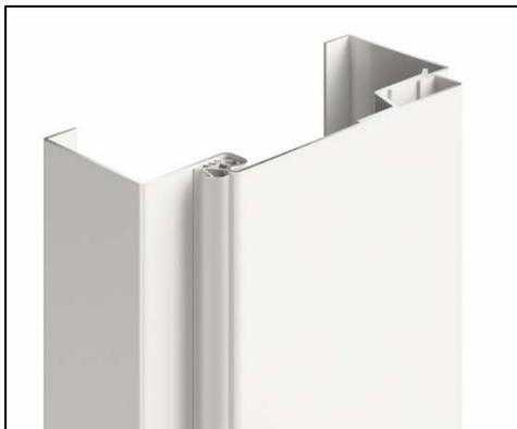
**Bild 3:** Bei der Montage der Stahlfutterzarge VarioFix von Hörmann entfällt die Arbeit mit Mörtel. So ist ein einfacher Einbau wie bei Holzzargen möglich. Zusätzlich deckt sie Toleranzen in der Wandstärke bis zu 20 mm ab.
