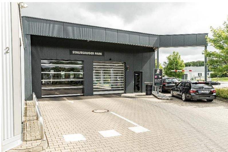
**Bild 2:** Das HS 5040 TurboLux von Hörmann sorgt mit seinen großen Sektionen aus durchsichtigem Polycarbonat für größtmöglichen Lichteinfall und eine ansprechende Optik. Etwa 90 Prozent des Torblatts sind transparent.
