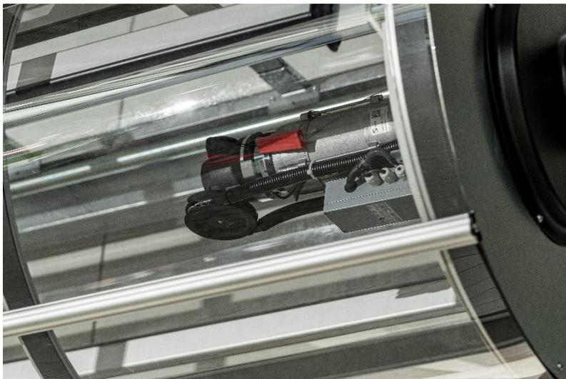
**Bild 4:** Der innenliegende Antrieb des Hörmann Schnellauftors HS 5040 TurboLux ist platzsparend in der Mitte der Spirale montiert. Das Stirnradgetriebe ist besonders verschleißarm und für mehr als 1 Mio. Zyklen ausgelegt.
