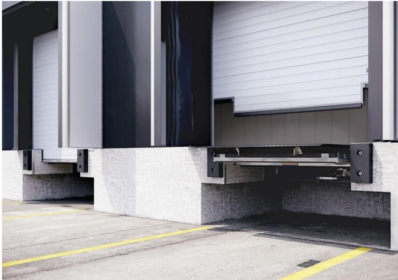
**Bild 6:** Neben gedämmten und schnell laufenden Toren sind auch energieeffiziente Verladekonzepte wichtig, wie z. B. die hydraulische Vorschubladebrücke HTL2 ISO von Hörmann, die mit 50 mm starken Isolationspaneelen für eine bis zu ca. 55 % bessere Wärmedämmung im Vergleich zu herkömmlichen Ladebrücken sorgt.
