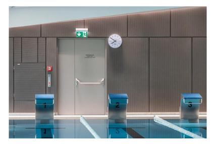
**Bild 7:** In der Schwimmhalle sind unter anderem 1-flüglige Stahl-Objekttüren mit Seitenteil von Hörmann verbaut. **Foto: Gerd Kressl**
