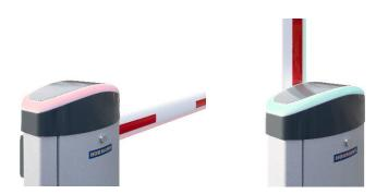
**Bild 5:** Die serienmäßige LED-Haubenbeleuchtung zeigt den Öffnungsstatus der Schranken SH 50 (hier abgebildet) und SH 100 von Hörmann an. Rotes Leuchten signalisiert, dass die Schranke geschlossen ist, grünes, dass die Schranke geöffnet ist.
