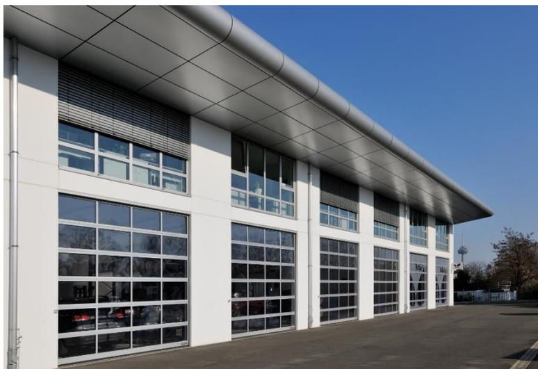
**Bild 5:** Das Industrie-Sectionaltor ALR 67 Thermo von Hörmann verfügt über 67 mm starke Lamellen und thermisch getrennte Verglasungsprofile. Somit verbindet es eine sehr gute Wärmedämmung mit maximaler Transparenz.
