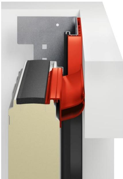
**Bild 3:** Der optionale Zargenanschluss ThermoFrame trennt die Zarge und das Mauerwerk thermisch, sodass die bereits sehr gute Wärmedämmung des SPU 67 Thermo um weitere 21 Prozent gesteigert werden kann.
