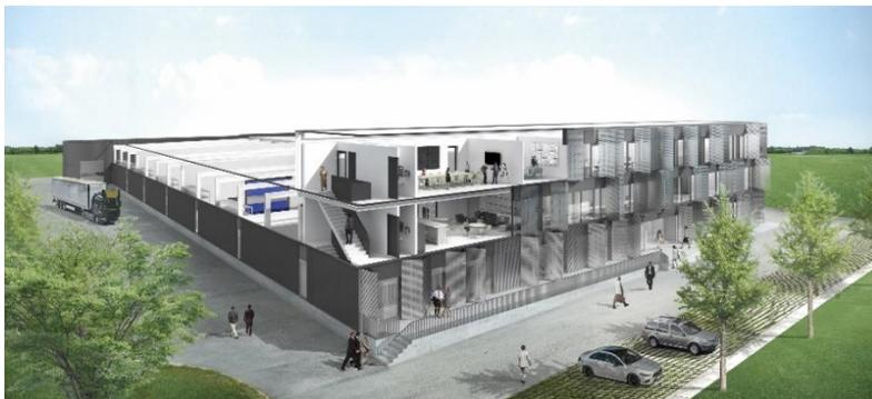
**Bild 2:** Alle Planungsdaten werden in einem zentralen 3D-Model erfasst, verarbeitet und vernetzt. Architekten und Planer können so zum Beispiel ein daraus generiertes Rendering für Freigabeprozesse beim Bauherren verwenden.
