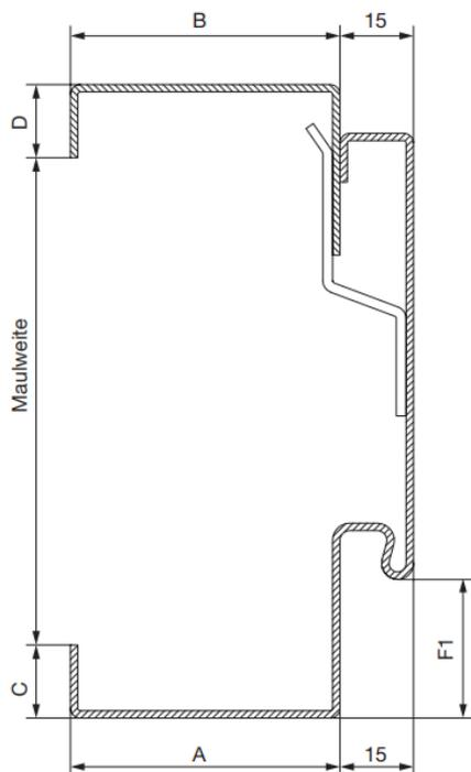
**Bild 4:** Die Hörmann VarioFix Zarge ermöglicht durch die verstellbare Maulweite von -5 mm bzw. +15 mm eine variable Montage für alle Wandarten. Die stoffschlüssige Befestigung erfolgt mit 2-K-Montageschaum. Sie eignet sich dadurch besonders für den Einsatz in Sanierungen.
