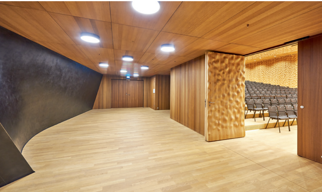
Der Kleine Saal wie auch die Schörghuber Türen sind mit speziell gefrästen Eichenhölzern ausgestattet.
