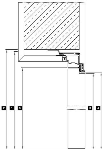
Horizontalschnitt mit reverse-öffnendem Türblatt
