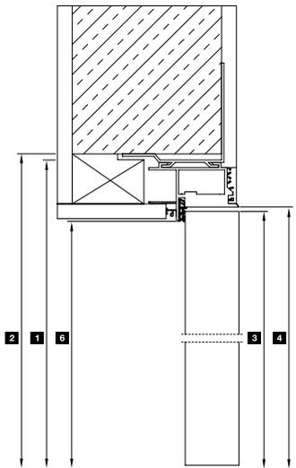
Horizontalschnitt mit stumpfem Türblatt
