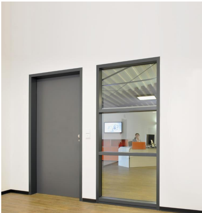
Bild 4: Die VarioFix Zarge von Hörmann mit Maulweitenverstellung aus Stahl ist vom Prinzip her zu montieren wie eine Holzzarge und deckt die Wandleibung ohne sichtbaren Umbug komplett ab.
