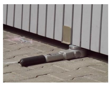
**Bild 4:** Bei Garagentoren ist es elementar, dass die zulässigen Betriebskräfte von maximal 400 Newton (ca. 40 Kilo) beim Auftreffen auf ein Hindernis eingehalten werden und das Tor innerhalb von 750 Millisekunden automatisch reversiert, also nach oben zurück fährt. Fachunternehmen können mit so genannten Messkeulen prüfen, ob dies der Fall ist.
