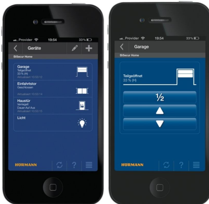
Bild 4: In der Hörmann APP wird über Symbole die Position der eingerichteten Tore und Türen sowie der Beleuchtung dargestellt.
