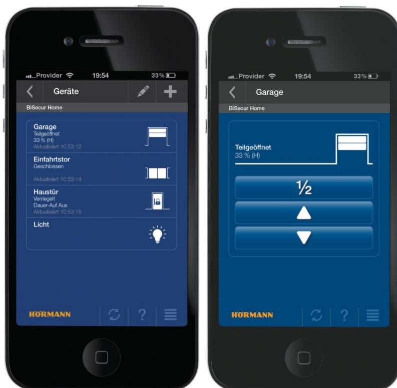
Bild 3: In der Hörmann BiSecur APP wird über Symbole die Position der eingerichteten Tore und Türen sowie der Beleuchtung dargestellt.
