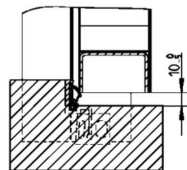
Anschlagsschwelle mit Dichtung
