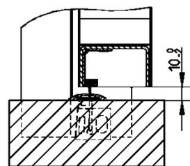
Auflaufschwelle mit Schleifdichtung
