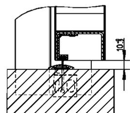
Auftauschwelle mit Schleifdichtung
