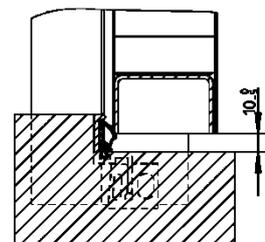
Anschlagsschwelle mit Dichtung
