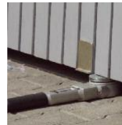
Bei Garagentoren ist es wichtig, dass die zulässigen Betriebskräfte von maximal 400 Newton (rund 40 Kilo) beim Auftreffen auf ein Hindernis eingehalten werden und das Tor innerhalb von 750 Millisekunden automatisch wieder hochfährt. Mit sogenannten Messkeulen (Bild) überprüfen Fachleute diese Betriebskräfte vor Ort.
