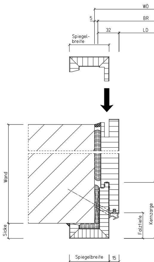
**Bild 3:** Bei Elementen mit Brand- und Rauchschuttfunktion erfolgt die Montage der Zarge zusätzlich über eine schräge
