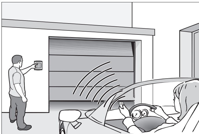
Abb. 4: Beispiel Funkbedienung eines Hörmann Garagentores mit Handsender und Funk-Codetaster
