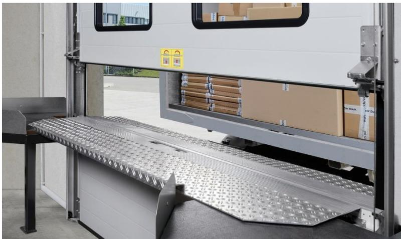
Für den Logistikbereich gibt es Industrie-Sectionaltore, die den Anforderungen von Verladestationen gerecht werden. Hersteller wie Hörmann ermöglichen mit dem teilbaren Industrie-Sectionaltor Parcel Walk, dass Nutzfahrzeuge mit diversen Größen an einer Verladestation be- und entladen werden können. Bei großen LKW wird nur der obere Teil des Tores geöffnet, während der Lamellensockel am Boden bleibt. Kleinere Transporter werden auf Hallenbodenniveau beladen, sodass das gesamte Tor geöffnet wird.
