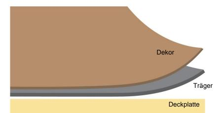
**Bild 9:** Bei dem Herstellverfahren der neuen Hörmann Duradecor Oberfläche werden das Dekor, der Träger und die Deckplatte in einem Arbeitsgang unter hohem Druck und nicht wie bei anderen Verfahren in mehreren Schritten verpresst. Dadurch ist diese Oberfläche wesentlich stoßfester und dadurch langlebiger als andere Innentüroberflächen.
