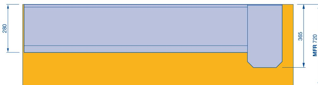
**BPA** Benötigter Platzbedarf für Montage und Demontage Antrieb
