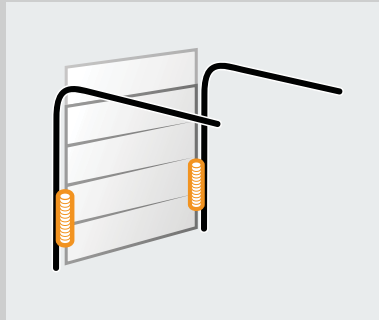
BZ-Beschlag: Zugfeder-Beschlag mit Zugfeder-Technik und flächenbündiger Blende
